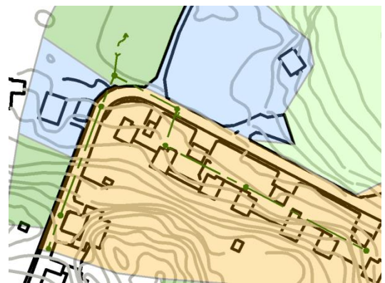
Figur 7. Befintligt separat dagvattenledningsnät med utlopp mot norr i skogsområdet avvattnar radhusområdet.
