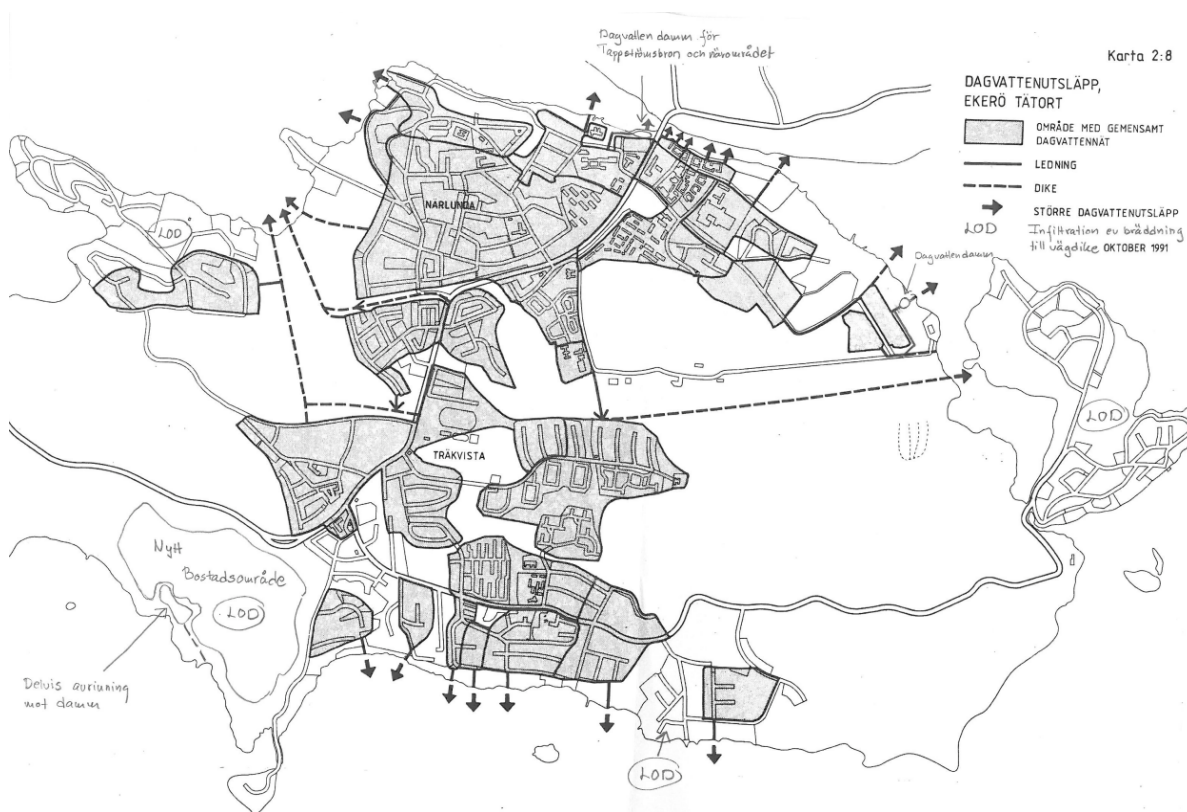
Figur 20 Skiss över det allmänna dagvattensystemet i Ekerö Centrum. LOD= lokalt omhändertagande av dagvatten
